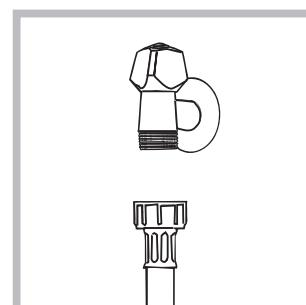
2. Прикрутите шланг подачи к водопроводному крану холодной воды с резьбовым отверстием 3/4 газ., (см. схему).
